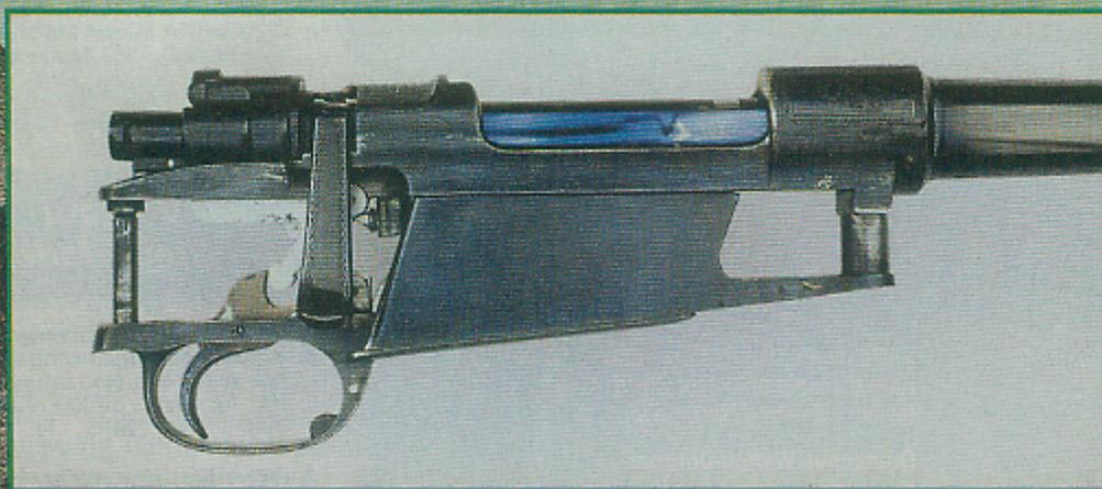
3 Das komplette System mit dem schrägen Magazinkasten. Der Magazindeckel kann nach unten geöffnet werden. Die Sperrklinke für den Deckel sitzt im Abzugbügel.
