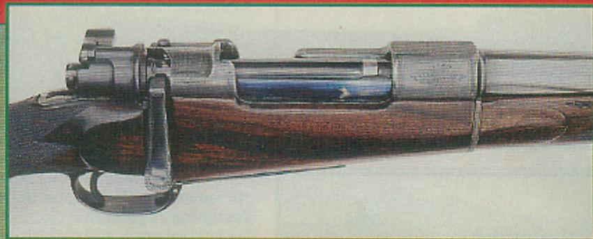
2 Die Büchse ist mit einem M-98-Verschluss in der verkürzten Zwischenversion – Short Intermediate System – ausgerüstet. Der Kammerstengel hat eine jählich flache Form.
