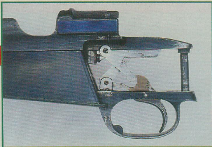
10 Diesen Flintenabzug erhielt die Firma Fraser patentiert. Das Abzugblatt wirkt auf den unteren Schenkel der Abzuggabel und bewegt über eine schmale Nase einen Hebel die Fangstange. Letztere wird beim Betätigen des Abzuges nach hinten – unten geschwenkt bevor die Abzuggabel die Schlagbolzenmutter freigibt. Es handelt sich dabei um eine Sicherungseinrichtung, ähnlich wie bei H&H-Seitenschlössen.
